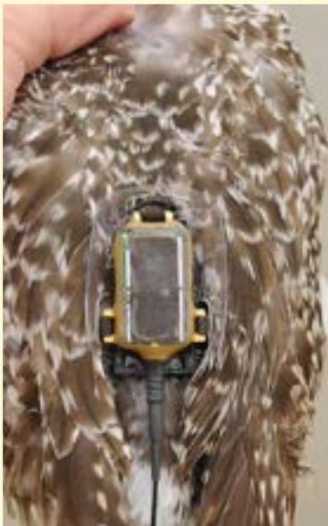
Der solarbetriebene Satellitensender wird auf dem Rücken eines Kiebitzregenpfeifers wie ein Rucksack befestigt. Die durchsichtige Kunststoffwanne um den Sender verhindert, dass Federn die Solarzelle abdecken. Foto: F. Hillig
